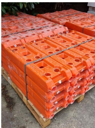
Plots béton + PVC
