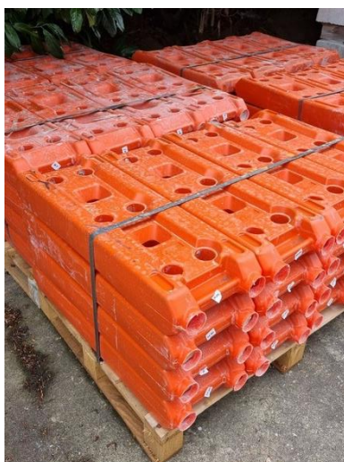
Plots béton + PVC
